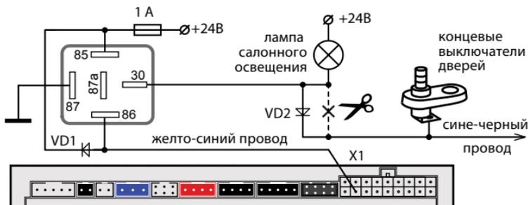
Дополнительный канал 4 также может быть использован для подключения к ближнему свету фар и реализации функции «световая дорожка». См. схему подключения далее:
