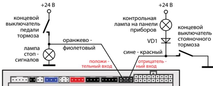
При подключении к стояночному тормозу в разрыв штатного провода стояночного тормоза необходимо подключить диод VD1, а вход автосигнализации подключить между катодом диода и концевым выключателем. В качестве VD1 может быть использован 1N4007 или аналоги.
