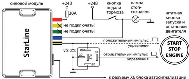
**Схема 2: слаботочное управление кнопкой «старт-стоп»**
