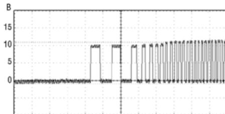
Момент прекращения прокручивания стартера автосигнализация определяет по резкому возрастанию частоты сигнала в момент начала работы двигателя. Подключение серо-черного провода к такой цепи гарантирует правильное отключение стартера.
