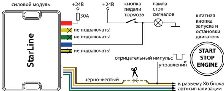
**Подключение входа контроля работы двигателя**
