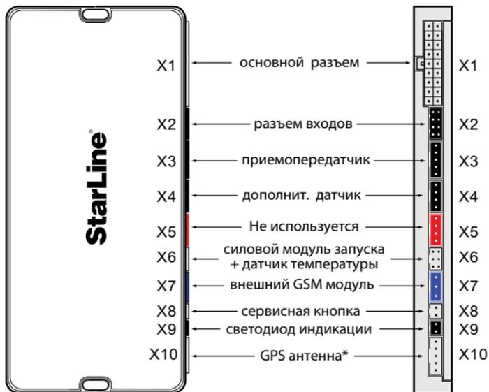
Подробная схема подключения автосигнализации приведена на стр. 50-51.
