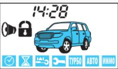
**!** Если двери, капот, багажник окажутся плохо закрыты, стояночный тормоз не затянут, педаль тормоза нажата или один из концевых выключателей дверей, капота, багажника неисправен (постоянно замкнут), то сигнализация предупредит об этом **4 сигналами сирены и 4 световыми сигналами** (см. «Самодиагностика при включении режима охраны», стр. 38).
