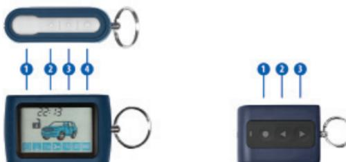
4-кнопочный брелок с обратной связью и жидкокристаллическим (ЖК) дисплеем
