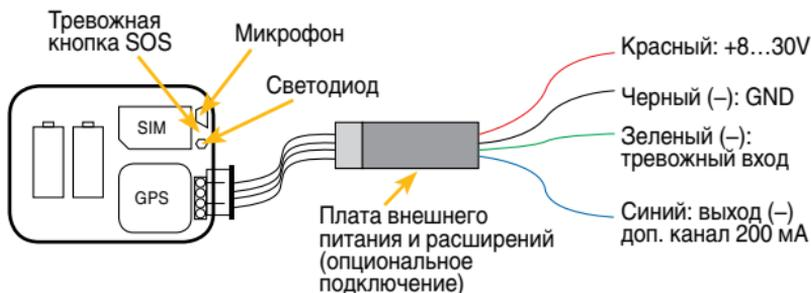
Для вывода жгута проводов на внешнюю плату питания и расширений в корпусе устройства предусмотрено специальное утончение, которое нужно прорезать ножом в случае использования внешних подключений. Утончение расположено в нижней половине корпуса рядом с прорезью для хомутов. Для прорезания отверстия необходимо извлечь плату устройства из корпуса.
