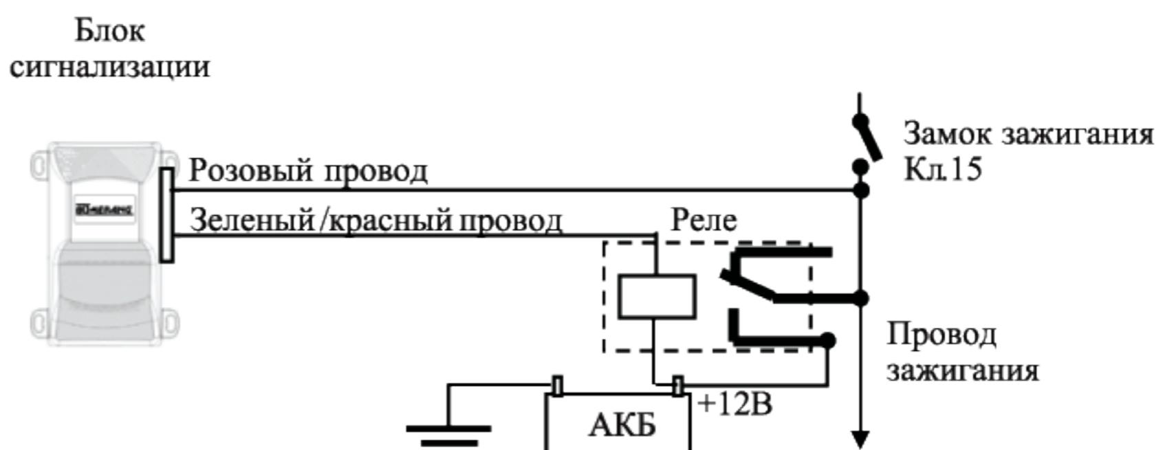
**Подключение нормально разомкнутого реле блокировки**
