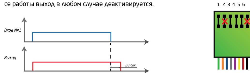
**19 Сдвиг импульса на 1 сек.** Через 1 секунду после нарастающего фронта сигнала по любому (одному) из входов активируется выход на оставшееся время активности данного входа + 1 сек. Условие работы выполнимо при времени активности входа более 1 сек. При сбросе питания в процессе работы выход в любом случае деактивируется.
