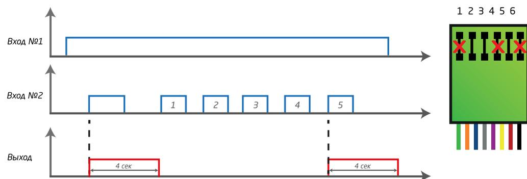
**39 Генератор прямоугольных импульсов.** (Меандр). При активном первом входе, система ждет нарастающего фронта по второму входу. При его появлении включает генератор прямоугольных импульсов на выходе (с частотой 1 Гц.). Генерация на выходе прекращается по спадающему фронту любого из входов, до появления условия: Активны оба входа (в любой последовательности).
