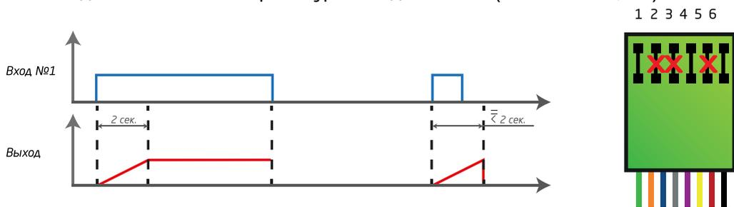
При длительности импульса на входе менее 2 сек., нарастание уровня на выходе прекращается, выход деактивируется. Длительность активности выхода определяется активностью входа. При сбросе питания в процессе работы выход в любом случае деактивируется.
