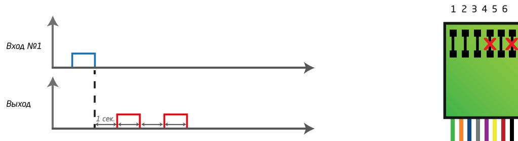
**7 Триггер по нарастающему фронту.** При нарастающем фронте сигнала на любом входе активируется выход на время до следующего нарастания фронта сигнала на входе. При сбросе питания в процессе работы устройства выход в любом случае деактивируется.
