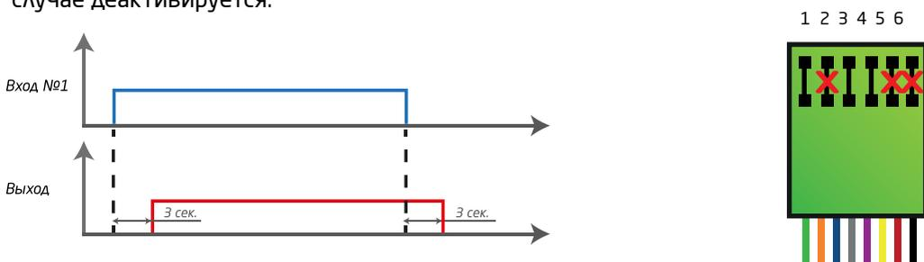
**21 Сдвиг импульса на 6 сек.** Через 6 секунд после нарастающего фронта сигнала по любому (одному) из входов активируется выход на оставшееся время активности данного входа + 6 сек. Условие работы выполнимо при времени активности входа более 6 сек. При сбросе питания в процессе работы выход в любом случае деактивируется.
