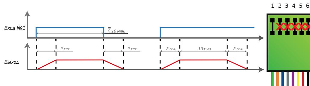
**33 Турботаймер 1 минута.** Вход №1 - замок зажигания, Вход №2 - педаль тормоза. Выход - зажигание. При активном входе №1 (замок зажигания) всегда активен выход (зажигание). Если зажигание (вх. №1) было включено более 5 минут, то после его выключения выход остается активным 1 минуту. Деактивация выхода нажатием педали тормоза (вх. №2). Если зажигание было включено менее 5 минут, то при его выключении выход тоже деактивируется.
