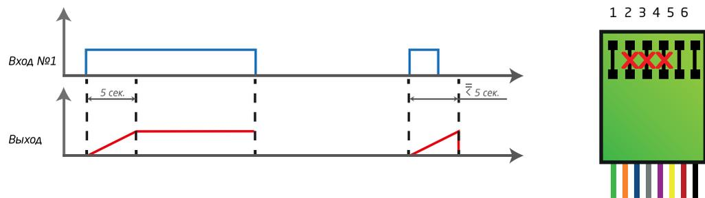
**30 Плавное включение за 10 сек.** При нарастающем фронте сигнала на входе, на выходе начинает плавно расти уровень до полного ( $U$  питания - 0,6 V.) за 10 сек. При длительности импульса на входе менее 10 сек., нарастание уровня на выходе прекращается, выход деактивируется. Длительность активности выхода определяется активностью входа. При сбросе питания в процессе работы выход в любом случае деактивируется.
