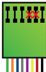
**8 Триггер по спадающему фронту.** При спадающем фронте сигнала на входе активируется выход на время до следующего спада фронта сигнала на входе. При сбросе питания в процессе работы устройства выход в любом случае деактивируется.
