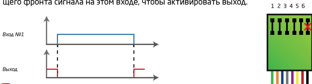
**3 Двойной импульс 1 сек. по фронту.** При нарастающем фронте сигнала на входе (не зависимо от его длительности) активируется выход двумя импульсами, длительностью 1 сек. с паузой 1 сек. При выполнении алгоритма работы выхода вход не контролируется. При сбросе питания в процессе работы выход в любом случае деактивируется.
