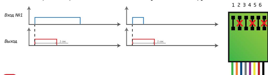
**23 Последовательный импульс 1 сек.** При спадающем фронте сигнала на входе активируется выход длительностью 1 сек. При сбросе питания в процессе работы выход в любом случае деактивируется.
