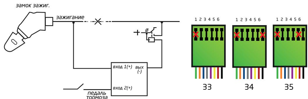
**34 Турботаймер 3 минуты.** Вход №1 - замок зажигания, Вход №2 - педаль тормоза. Выход - зажигание. При активном входе №1 (замок зажигания) всегда активен выход (зажигание). Если зажигание (вх. №1) было включено более 5 минут, то после его выключения выход остается активным 3 минуты. Деактивация выхода нажатием педали тормоза (вх. №2). Если зажигание было включено менее 5 минут, то при его выключении выход тоже деактивируется.
