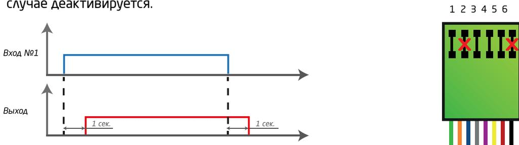
**20 Сдвиг импульса на 3 сек.** Через 3 секунд после нарастающего фронта сигнала по любому (одному) из входов активируется выход на оставшееся время активности данного входа + 3 сек. Условие работы выполнимо при времени активности входа более 3 сек. При сбросе питания в процессе работы выход в любом случае деактивируется.
