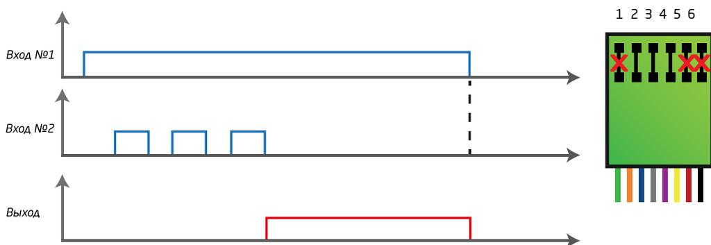
**37 Секретка (Н3).** Выход блокировки деактивируется после набора кода. Подключите питание устройства к зажиганию и два входа к штатным кнопкам автомобиля которыми вы хотите отключать блокировку. При включении зажигания активируется выход устройства. Отключение блокировки: Включить зажигание, в течение 10 сек. удерживая нажатой кнопку подключенную к 1 входу, три раза нажать кнопку подключенную к 2-му входу, на выходе пропадет потенциал (станет не активным).
