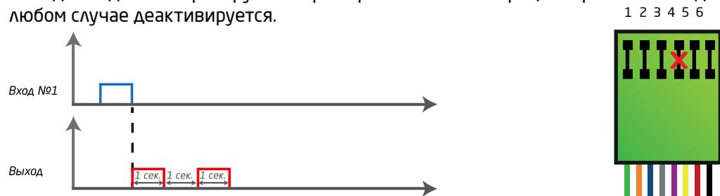
**6 Двойной импульс 1 сек. по спаду с задержкой 1 сек.** При спадающем фронте сигнала на входе, с паузой 1 сек. активируется выход двумя импульсами, длительностью 1 сек. с паузой 1 сек. При выполнении алгоритма работы выхода вход не контролируется. При сбросе питания в процессе работы выход в любом случае деактивируется.
