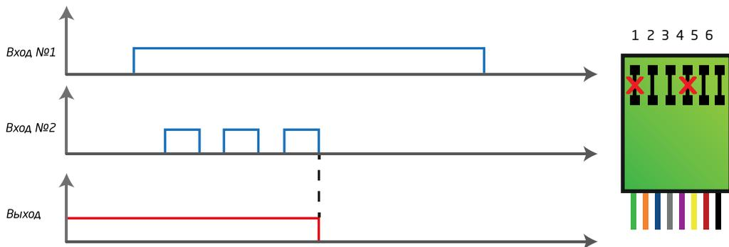
Весь процесс набора кода не должен превышать 10 секунд с момента включения зажигания. При неправильном вводе, или превышении 10 секундного интервала ввода, выключите зажигание и повторите попытку. Вход может быть подключен к аналоговой кнопке автомобиля, дополнительной секретной кнопке, концевому выключателю педали тормоза, концевому выключателю двери и т. д.
