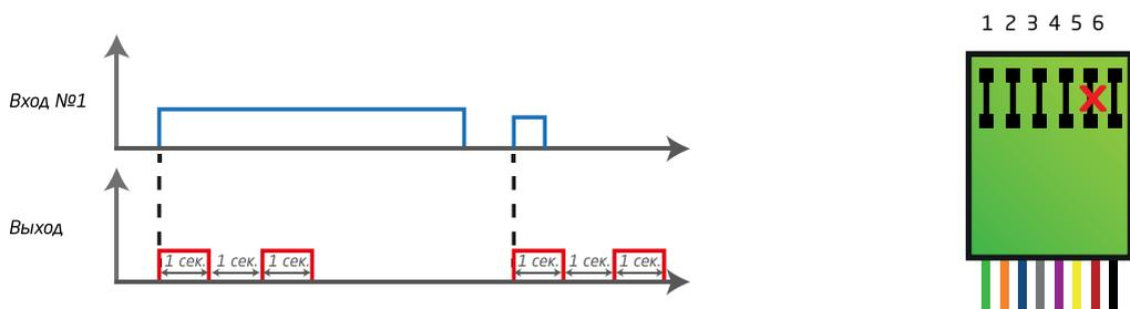
**4 Двойной импульс 1 сек. по фронту с задержкой 1 сек.** При нарастающем фронте сигнала на входе (не зависимо от его длительности) активируется выход двумя импульсами, длительностью 1 сек. с паузой 1 сек. При выполнении алгоритма работы выхода вход не контролируется. При сбросе питания в процессе работы выход в любом случае деактивируется.
