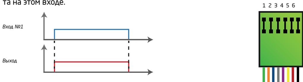
**2 Инвертор.** При неактивных входах активен выход. По нарастающему фронту сигнала на любом (одном) входе выход деактивируется. При спадающем фронте на входе, выход снова активируется. При сбросе питания система смотрит за состоянием входов и если хоть один активен, деактивирует выход и ждёт спадающего фронта сигнала на этом входе, чтобы активировать выход.
