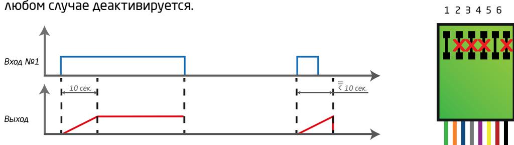
**31 Ограничитель времени работы освещения 10 минут.** При нарастающем фронте сигнала на любом (одном) входе активируется выход на время активности данного входа (но не более 10 минут). Деактивируется выход по спадающему фронту сигнала на входе. При сбросе питания система смотрит за состоянием входов и если хотя бы один активен, активирует выход на время активности данного входа (но не более 10 минут) и ждёт спадающего фронта на этом входе.
