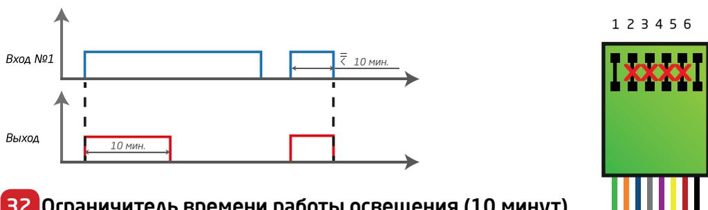
**32 Ограничитель времени работы освещения (10 минут) с плавным включением и выключением.**
