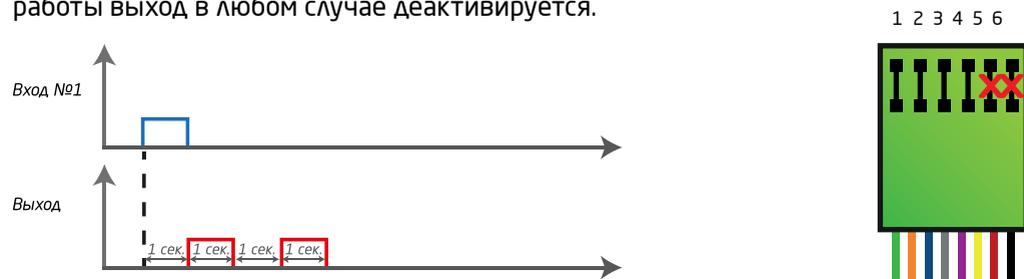
**5 Двойной импульс 1 сек. по спадающему фронту сигнала.** При спадающем фронте сигнала на входе активируется выход двумя импульсами, длительностью 1 сек. с паузой между импульсами тоже 1 сек. При выполнении алгоритма работы выхода вход не контролируется. При сбросе питания в процессе работы выход в любом случае деактивируется.
