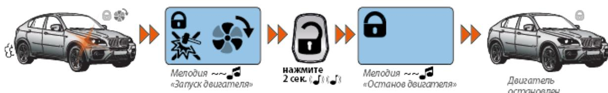
За одну минуту до штатной остановки двигателя на брелок придет оповещение об этом событии. На брелоке замигает пиктограмма и 1 раз в 10 сек. будет звучать мелодия «Останов двигателя через 1 мин.». При этом можно отправить команду продления работы двигателя:
