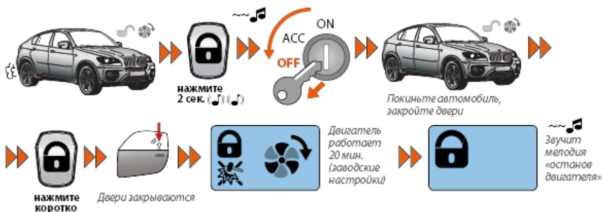
В системе Pandora DXL режим «Поддержки зажигания» организован штатным образом с использованием «Реле поддержки зажигания и блокировки». Время работы режима задается программно в меню программирования (**Заводская установка 20 мин.**).
