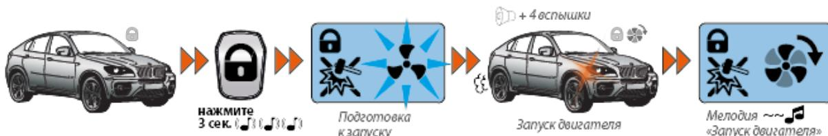
Для останова двигателя, находящегося в режиме прогрева дистанционно, необходимо нажать и удерживать кнопку брелока в течение двух и более секунд. Двигатель будет немедленно остановлен, что подтвердит звуковой сигнал «Двигатель остановлен» и погасшая пиктограмма вентилятора.
