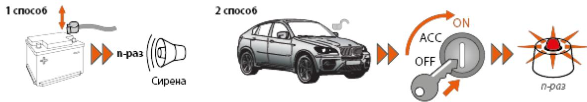
Проверить количество прописанных брелоков в систему можно, сняв и одев обратно клемму аккумулятора, при этом система количеством звуков сирены известит, сколько прописано брелоков. Также проверить количество брелоков можно по количеству оранжевых вспышек индикатора состояния при каждом включении зажигания при выключенном охране. Проверяйте периодически количество прописанных брелоков для полной уверенности в противоугонной стойкости системы.
