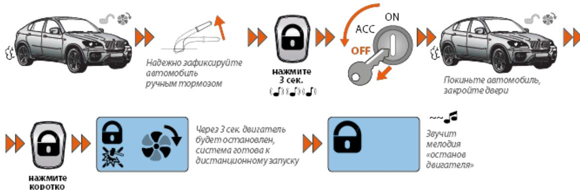
Если разрешен подуровень II-3.8 «Автоматическое включение программной нейтрали», то процедура «Программная нейтраль» будет автоматически выполняться при поднятии ручника. Неисполнение процедуры «Программная нейтраль» влечет за собой отказ системы выполнять команды дистанционного и автоматического старта двигателя.
