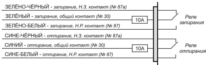
Перед подключением системы к установленным электроприводам замков дверей необходимо определить тип штатной системы центрального замка. Для этого – выньте выключатель дверного замка из панели двери водителя и протестируйте провода, идущие от выключателя.
