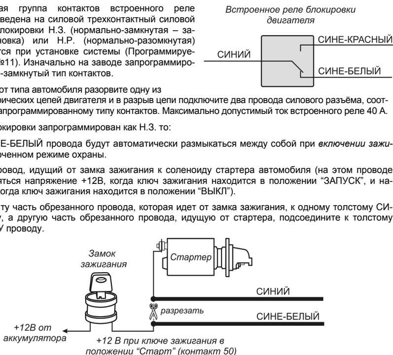
**Примечание:** Обратите внимание на то, что при использовании такого варианта подсоединения питание на реле блокировки будет подаваться только в момент попытки завести двигатель, таким образом, реле блокировки будет потреблять энергию аккумулятора только в момент попытки запуска двигателя.
