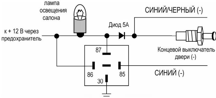
При положительных концевых выключателях дверей:
