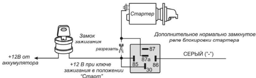
Схема подключения СЕРЫГО провода для блокировки цепи зажигания автомобиля:
