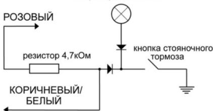
Вариант 2 лампа стояночного тормоза на приборной панели
