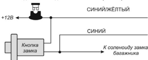
**Подсоединение:** Для дистанционного отпирания замка багажника подсоедините ТЕМНО-СИНИЙ провод и ТЕМНО-СИНИЙ/ ЖЕЛТЫЙ провод системы как показано на схеме.
