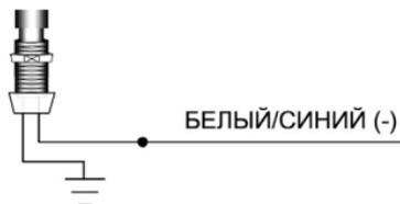
Кратковременная подача сигнала отрицательной полярности на данный вход системы аналогична 2-секундному нажатию кнопки \* передатчика и будет вызывать запуск или глушение двигателя.
