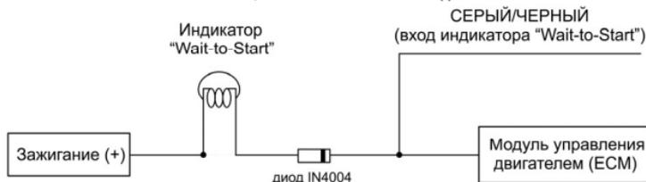
**Примечание:** В штатный провод включения лампы между самой индикаторной лампой и модулем управления двигателем (ECM) необходимо установить диод, рассчитанный на ток 1 А.
