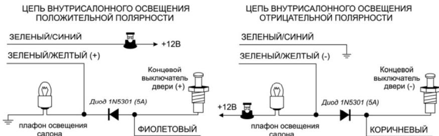
**ВНИМАНИЕ:** **Обязательно** используйте диод для изолирования цепи управления внутрисалонным освещением от цепи триггера двери. В противном случае не сможет правильно работать функция пассивной постановки на охрану и функция автоматической повторной постановки системы в режим охраны.
