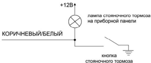
**Примечание:** В некоторых автомобилях со светодиодной панелью приборов и ручной коробкой переключения передач для обеспечения работы системы дистанционного запуска двигателя необходимо ввести развязку КОРИЧНЕВОГО/БЕЛОГО провода и концевика стояночного тормоза автомобиля. Сделать это можно двумя способами:
