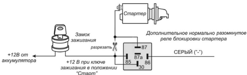
**Примечание:** Обратите внимание на то, что при использовании такого варианта подсоединения питание на реле блокировки будет подаваться только в момент попытки завести двигатель, таким образом, реле блокировки будет потреблять энергию аккумулятора только в момент попытки запуска двигателя.
