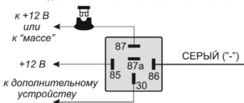
**Подсоединение:** Подсоедините SERPый провод к клемме № 85 дополнительного 30А реле, подсоедините клемму № 86 реле к +12В. Подсоедините остальные контакты реле в соответствии с выбранной функцией канала 3 системы.
