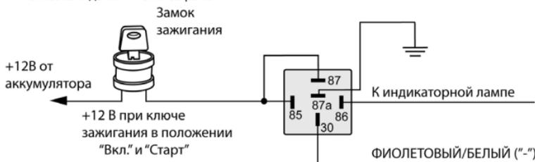
**ВНИМАНИЕ:** При использовании лампы давления масла невозможно реализовать функцию автоматического запираания дверей при повышении оборотов двигателя (программируемая функция № 1.4).
