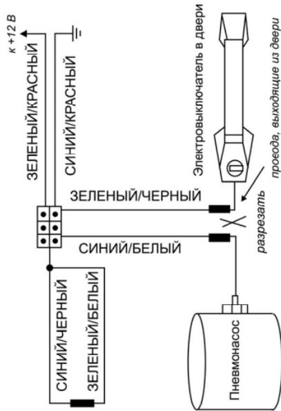
Схема 5. Однопроводный тип цепи дверных замков с оптической полярностью (некоторые автомобили марки Ниссан, Mazda и др.)
