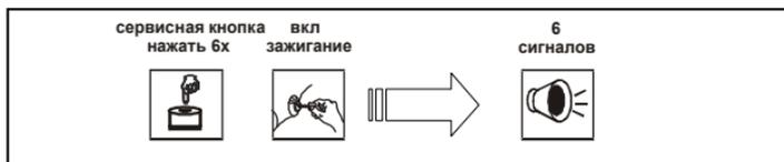
3. Нажимайте сервисную кнопку для продвижения по функциям от 1 до 15. Каждое нажатие сервисной кнопки выбирает очередную по номеру функцию. Номер выбранной функции отображается вспышками светодиода и сигналами сирены. Расшифровка сигналов сирены и вспышек приведена внизу в таблице.
