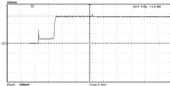
**Возможные трудности:** на некоторых автомобилях сигнал генератора изменяется на соответствующий работающему двигателю уже при прокручивании стартера. В данном случае, гарантировать корректное прекращение работы стартера невозможно и этот способ контроля лучше не использовать.
