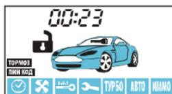
2. Войдите в режим установки PIN-кода. При выключенном зажигании нажмите сервисную кнопку 4 раза. Каждое нажатие сопровождается загоранием светодиодного индикатора.
