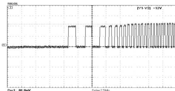
В качестве сигнала пропорционального скорости вращения двигателя также может быть взят сигнал от цепи управления форсунками. В большинстве случаев он позволяет надежно определять состояние работающего двигателя.
