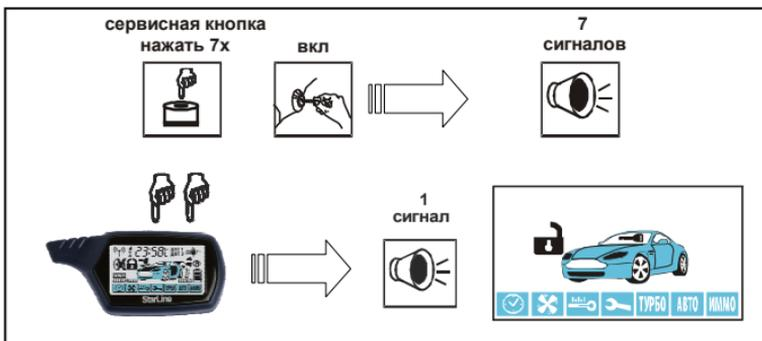
4. Повторите пункт 3 для всех записываемых брелков. Интервал между записью каждого брелка не должен превышать 5 секунд. Успешная запись каждого нового брелка подтверждается соответствующим количеством сигналов сирены.
