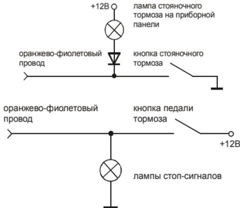
На автомобилях с автоматической КПП подключите этот провод к кнопке педали тормоза, замыкающейся на +12В при нажатии педали тормоза.
