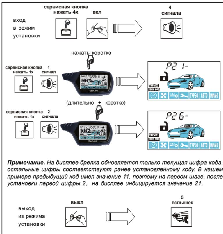
**Примечание.** На дисплее брелка обновляется только текущая цифра кода, остальные цифры соответствуют ранее установленному коду. В нашем примере предыдущий код имел значение 11, поэтому на первом шаге, после установки первой цифры 2, на дисплее индицируется значение 21.
