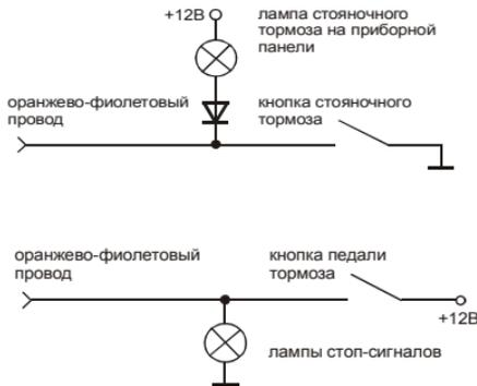
Подключение к выключателю стояночного тормоза, который замыкается на корпус при включении тормоза.
