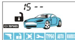
**вариант 4** - работа канала в режиме «защелка», когда включение / выключение канала осуществляется дистанционно с брелка. На время работы канала в режиме охраны датчик удара и дополнительные датчики не отключаются.
