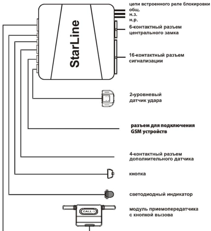
Подключение 16-контактного разъема
