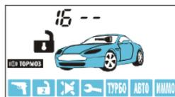
**вариант 4** - работа канала в режиме поддержки +12В на контакте IGN1 (15/1) замка зажигания при активации режима охраны с работающим двигателем. Поддержка зажигания происходит автоматически при работающем двигателе (или включенном зажигании) при затягивании ручного тормоза. Время нахождения в режиме поддержки зажигания не ограничено. Поддержка будет выключена при выключении зажигания или при отпускании ручного тормоза.
