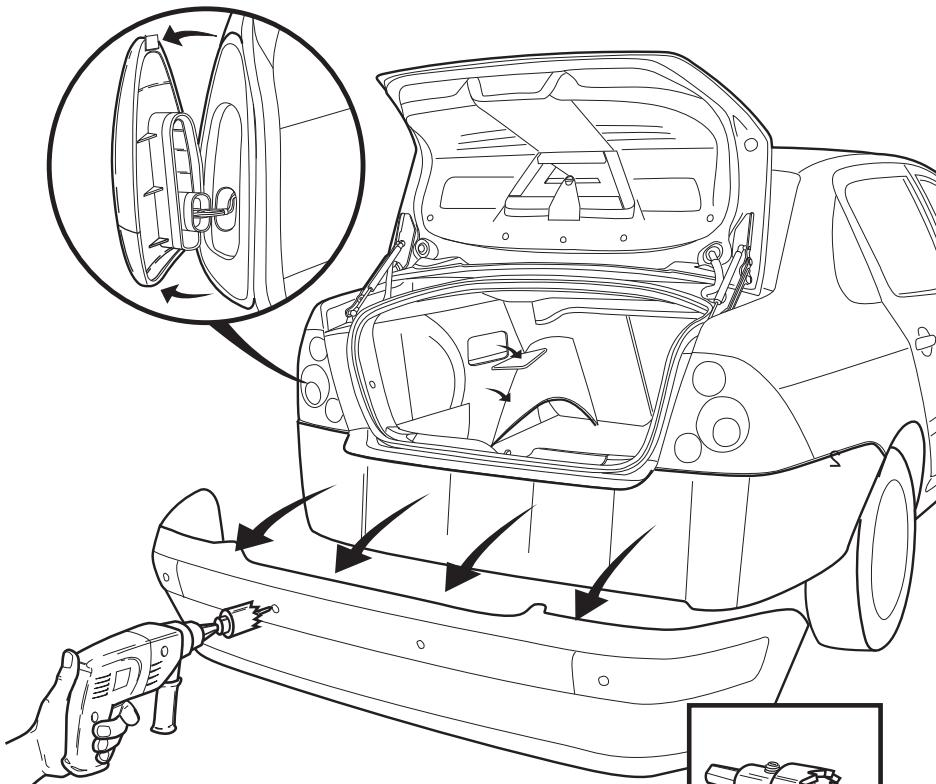
Проверьте перед работой, диаметр датчика должен совпадать с диаметром фрезы.
