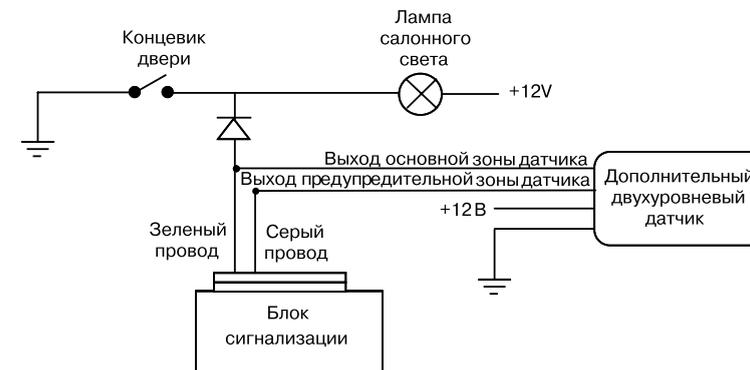
**Примечание:** При включенном режиме “Предупредительная зона датчика” в случае постановки на охрану с открытой дверью (включенным салонным светом) программируемый вход будет отключен и взят под охрану через 15 секунд после закрытия двери (выключения света).
