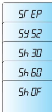
☞ При установке режима 'Sh OF' датчики шок-сенсора не будут работать.
