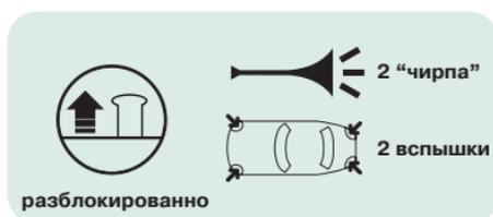
➡ Если Вы не открыли двери машины, в течение примерно 30 секунд после снятия с охраны, двери вновь запираются, и автоматически включается охрана.
