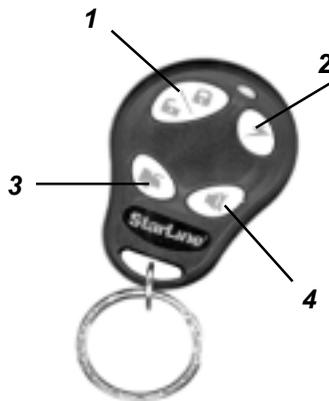
В четырехкнопочном брелке без обратной связи используется литиевый элемент питания CR2032, 3В. Время работы одного элемента питания зависит от частоты пользования брелком и от типа установленного элемента.
